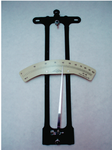
59-njy surat. Gylly gigrometr. 1 – dil; 2 – şkala; 3 – ýokarky gysgýç; 4 – gyl; 5 – çarçuwa; 6 – aşaky gysgýç
