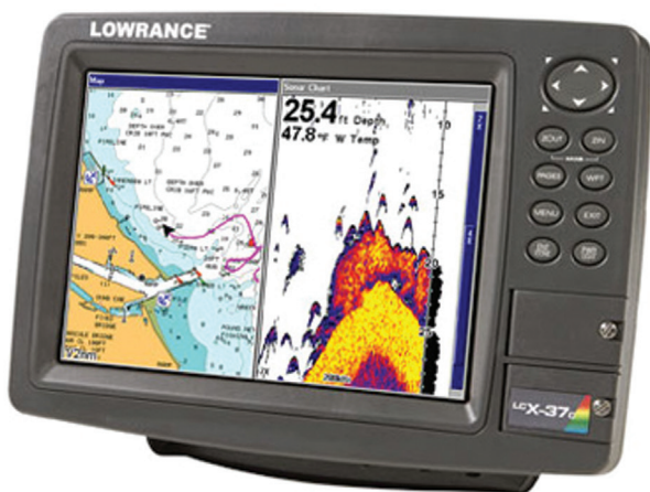
4.7-nji surat. GPS tehnologiýaly eholot
