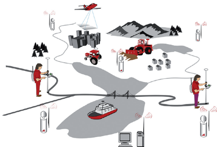
4.18-nji surat. Dürli meseleleri çözmek üçin niýetlenilen bazaly stansiýalar we GPS torlary
