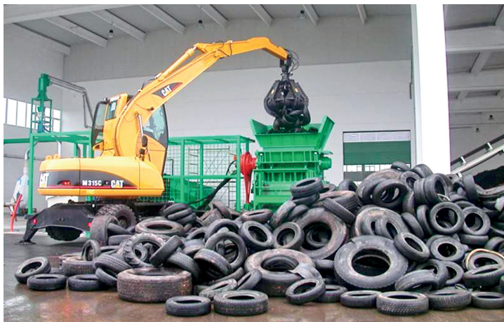
85-nji surat. Asfalt betonyna goşulýan reziniň taýýarlanylşy
