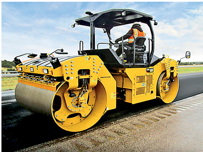
83-nji surat. Asfalt örtügini dykzlandyryýan aram agyrylykdaky katok
